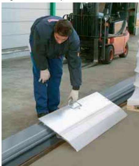
Pozicioniranje nosilnega mostu na tla vagona in na vodljivo tirnico.
