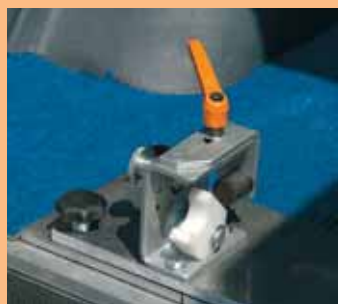
Zaklepni zapah za pritrditev klančine v notranjosti vozila.
